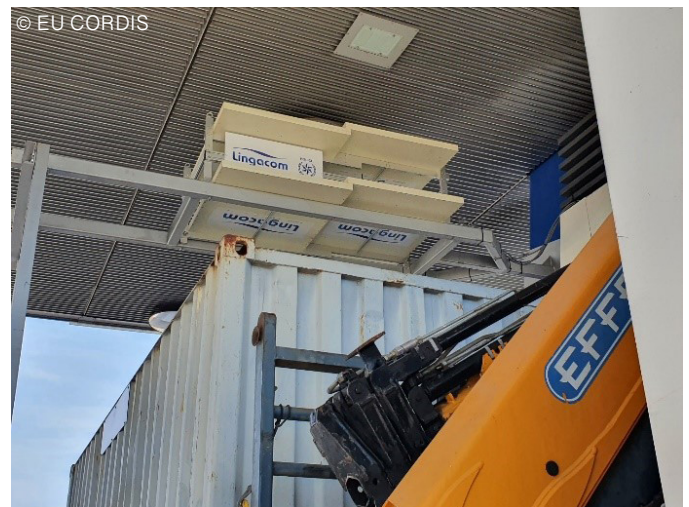
การทดลองใช้เครื่องเอกซเรย์อนุภาคมิวออน
