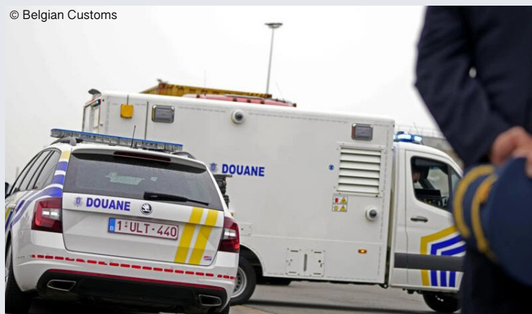
รถบรรทุกเครื่องเอกซเรย์เคลื่อนที่ (Mobile Container Scanner) ของศุลกากรเบลเยียม
